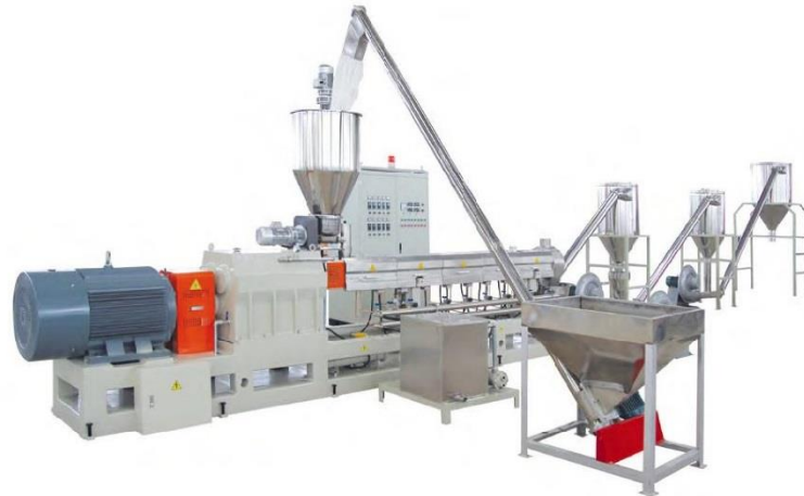
Рисунок Б.1 – Двухстадийный смеситель для подготовки смеси ДПК
